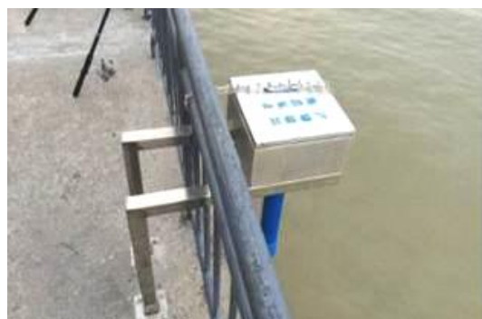
图 31 咸潮入侵在线监测海鸥岛观测站
