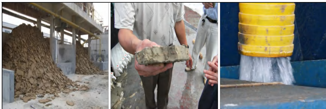
图 2.3-5 经过压滤干化系统处理的渣土和水
